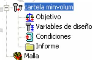
3. Con el botón derecho sobre **Objetivo**, estableceremos cual es el objetivo de nuestro diseño. Seleccionaremos *agregar* un objetivo de *minimización del volumen*, basado en el *ensayo estático* y con un *error* en la convergencia del 5%.
