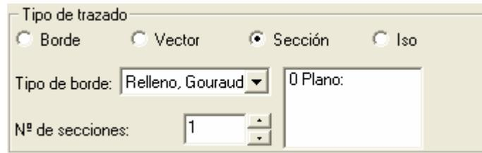
Aceptar y con el botón derecho sobre ese nuevo *trazado*, seleccionar *Recorte...*, observar que moviendo los cursores podremos seleccionar cualquier plano de corte.
